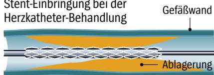
Ein zusammengefaltetes Gitterröhrchen (Stent) wird mit dem Ballonkatheter bis zur verengten Stelle vorgeschoben.
